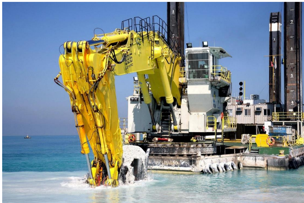
Figur 2 Gravemaskine monteret på pram
